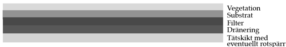
Figur 6 Generell uppbyggnad av grönt tak 8 .
